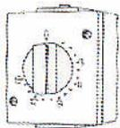
Hunter Zeitschaltuhr für Tennisanlagen und Reithallen; zur Halbautomatischen Steuerung vom Platz aus; einstellbare Laufzeit 0-15 Minuten; 2-polig 16A, 250V; Gehäuse 90x70mm
